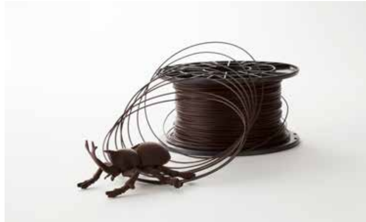
改質リグニンと生分解性材料を組み合わせた3Dプリンター用基材と造形物
