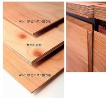
**概要** 国産の杉合板をベースに両面にセندانのt4mm挽き板を貼り合せパネル化した。これで薄くて寸法安定性を維持しながら、広い部材の製作が可能になった。しかも、表面はt4mmの無垢材なので、ビスの保持力も高まり、表面の凹凸加工も、多少の面取りも無垢板と同様に加工できる。ケヤキに似た豊かな表情をもつ材となった。
