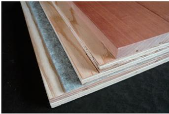
**概要** 一般的な木質フローリングの床では、転倒衝突時の安全性やかたさなどの居住性に関する性能が十分ではないことがこれまでの検討によって明らかになっている。よって、木質フローリングを前提としながら下地を工夫する事で居住性をバランスよく向上させた床を開発し、主に保育園や高齢者施設で利用される事を想定している。
