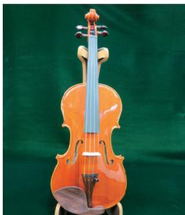
**概要** 細やかな施業体系により育林された奈良県産優良スギ材は緻密な年輪構造を有し、強く・美しい。この特徴を活かすための新たな利用を探るため、県産スギ材の音響特性を調べるとともにバイオリンを開発した。実際の演奏シーンで活用されることを視野に、バイオリン・バイオリン製作者より情報収集して製作を進めた。
