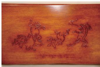
**概要** 通常、木材の浮彫加工には、高い彫刻技術や特殊な工作機械が必要であるが、今回提案する方法を使えば、誰でも容易に線画や点字の浮彫ができる。できあがった製品の表面はあらかじめ精緻な研磨が行われているため機械仕上げに比べ手で触った時の感触が良い。木工芸品の加飾に使えるだけでなく、図工教材としても有用。
