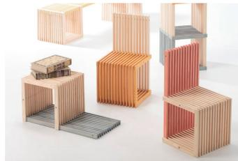
**概要** 岡山県の主要材であるヒノキを、インテリアに活かすことを目標に研究開発した卒業制作。単ユニットは軽く薄い14組の枠を、細く硬いバネで結束しており、スリット同士を噛み合わせて自由に棚を構築できる。ヒノキ材の人肌感覚、淡い草木染めと格子状のスリットが、軽快な棚空間を作り上げる。
