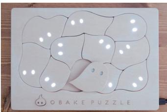
**概要** 1つ1つのピースが様々な形のおばけのパズル。一見普通の木工パズルに見えるが正解の位置にピースが来ると目が光る当作品は、細部まで丁寧に仕上げられた木製ピースの内部に超薄型電磁誘導基板を埋め込んでおり、一見木工にしか見えないものが光るといった驚きを与える点に新規性がある。
