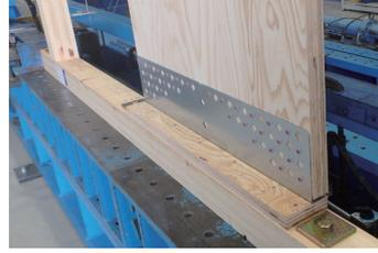
**概要** 熊本地震以降、倒壊しないのは勿論、補修は必要だが住み続けられる建物が顧客から求められている。一方、一定量以上の耐力壁の増加により建物の耐震性能は確保できるが、プランに制限が生じてしまう。そこで本技術は雑壁である引き戸の袖壁等を耐力要素として活用し、建物プランの変更を抑えて耐震性能の確保が図れる。
