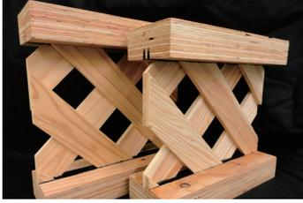
**概要** 木造在来工法住宅の国産材利用率は、柱・土台では50%程度のシェアだが横架材では9%にとどまる。断面効率のよい木材の使い方ができれば、横架材にも国産材が使えようと考え、ウェブに国産スギの斜め格子面材を用い、フランジに国産カラマツのLVLを用いたI形梁を開発した。
