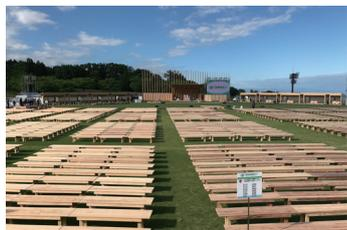
**概要** イベント参加者の着席用として設置するシンプルで多目的に使用できるベンチ。運搬・設置・撤去がしやすい軽さに留意した。杉の大径材が増えているので有効利用し、辺材(白太)のみを使用、赤味と比べて2割も軽量化した。熱伝導率が低く、座板が暖かく木の良さが伝わる。スタッキング機能を持ち、運搬・保管がしやすい。
